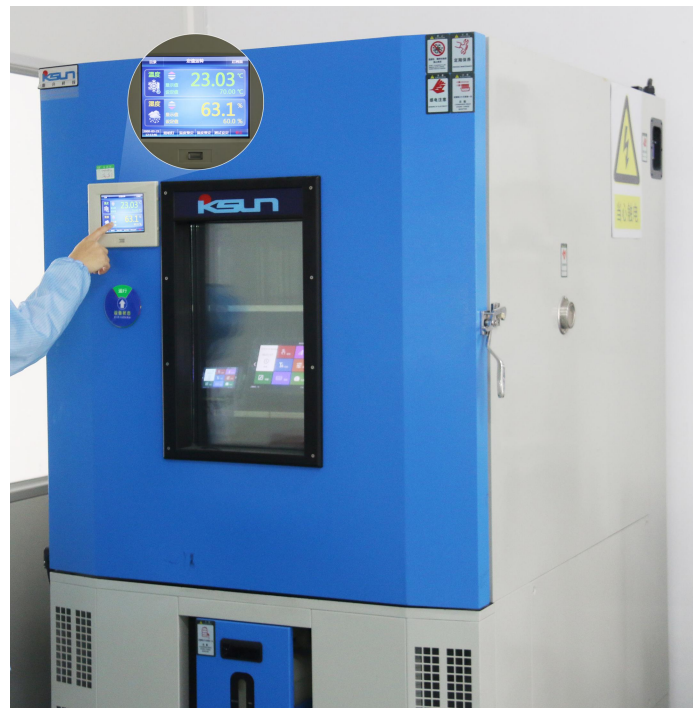
图 4-7 高低温老化测试图
